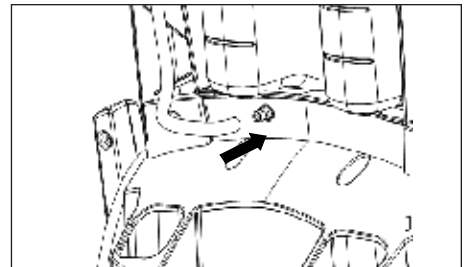
Figura 10 - Sujete el tubo del jabón a la unidad (modelos PW1825 y PW1835 solamente)
