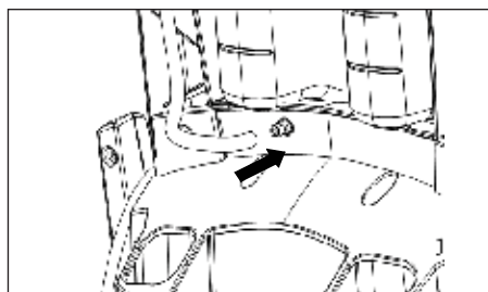
Figure 10 - Attachez le tube de savon à l'unité (seulement pour les modèles PW1825 et PW1835)
