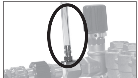
Figura 3 – Inyector de productos químicos
