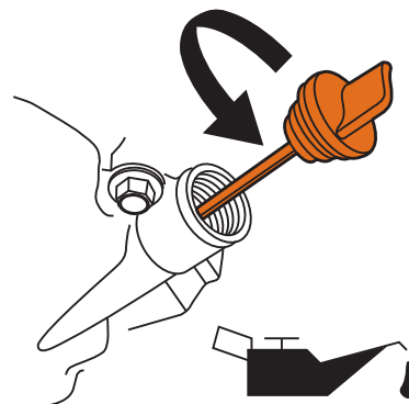
Figura 31 – Llenado de aceite del motor
