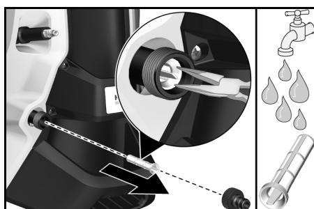
4. Coloque el tamiz en la conexión de agua.
