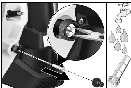
4. Mettre le tamis en place dans le raccord d'alimentation en eau.
