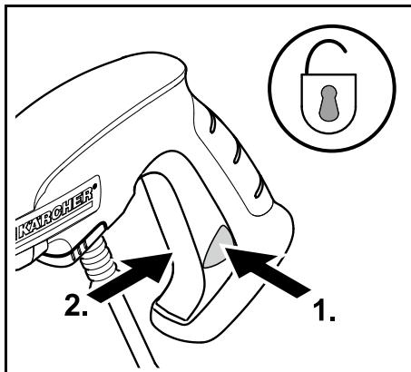
4. Encienda el dispositivo; para ello, tire de la palanca de la pistola de accionamiento.
