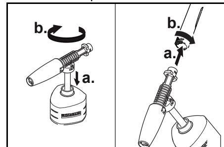
3. Inserte el cañón de espuma en la pistola de accionamiento y gírela 90° para bloquearla.
