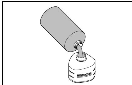
2. Conecte el tanque de detergente al cañón de espuma.
