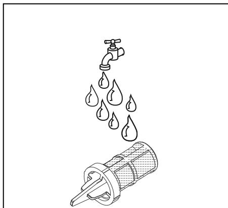
4. Coloque el tamiz en la conexión de agua.
